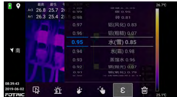
本机即时分析热像图和分区设置发射率
