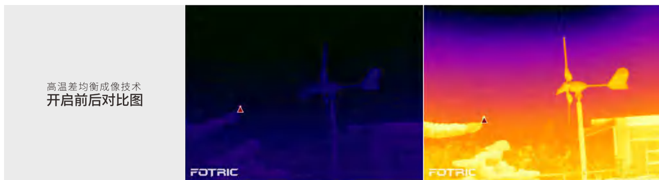
高温差均衡成像技术 开启前 的热像图
