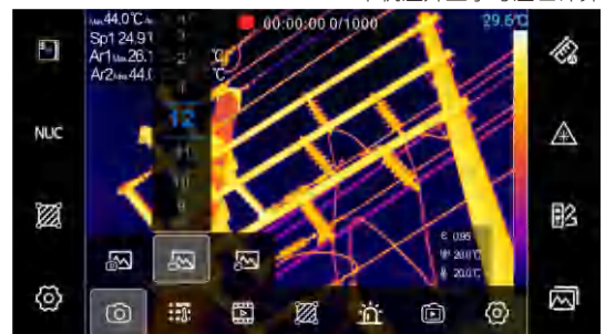
本机全辐射热像小视频录制
