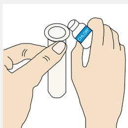
1. 取下CHLOR\*EXTRACT 溶液瓶盖，将整瓶溶液倒入测试套中。
