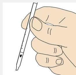
5. 立即取出测试套，在颜色变化界面上，获取滴定管上的读数。粉红色显示正常，白色代表氯化物的含量。
