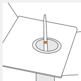
4. 将装有浸提液和滴定管的测试套插入之前盒盖中自带的孔中，等待1分半。
