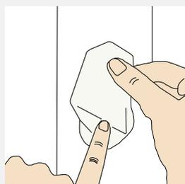
2. 紧压测试套和测试表面，提取溶液，使其接触测试表面。
