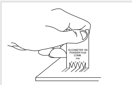
将湿膜梳插入粉末涂层，并沿着表面滑动。测量点（齿部）是尖的，使得粉末可在齿部周围流动。
