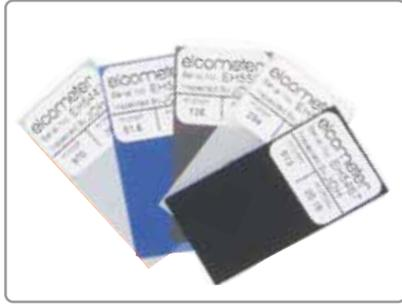
使用校准膜片或“夹片”是在基体材质，表面加工和表面形态上建立涂层厚度标准的最便捷的方式。这是调节测厚仪校准的最理想的方式，可确保能达到最高精确度。
