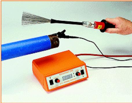
Elcometer 236 直流孔隙探测仪
