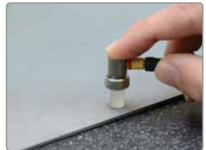
理想用于测量未涂覆金属材料薄片厚度和其他薄,金属基板。
