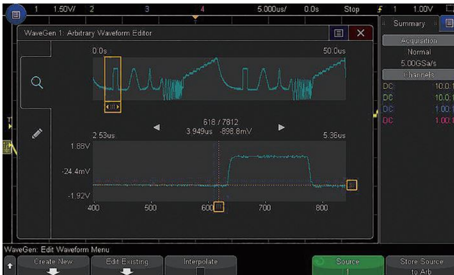
图 25: 在仿真分析方面，集成的任意波形发生器使得捕获、修改和回放信号变得轻而易举。
