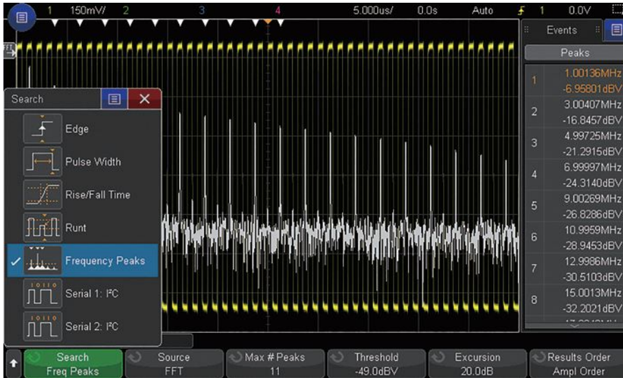
图 14: 把 3000T X 系列设置为捕获用于 FFT 分析的时钟信号。使用搜索和导航功能，示波器能够查找、标记(白色三角形)并快速导航到最先出现的 11 个频率峰值。您可以按照频率或幅度的次序进行排序。
