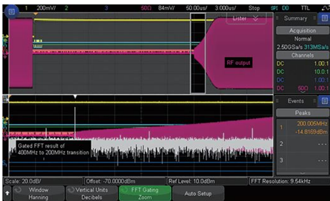
图 21c: 开始发现在 200MHz 上的射频信号。您也能通过射频模拟波形进行验证
