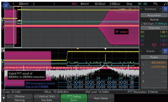
图 21a: 在 SPI 命令上触发时，射频信号的频率仍然是 400 MHz，如列表显示器中的频率峰值搜索结果所示
