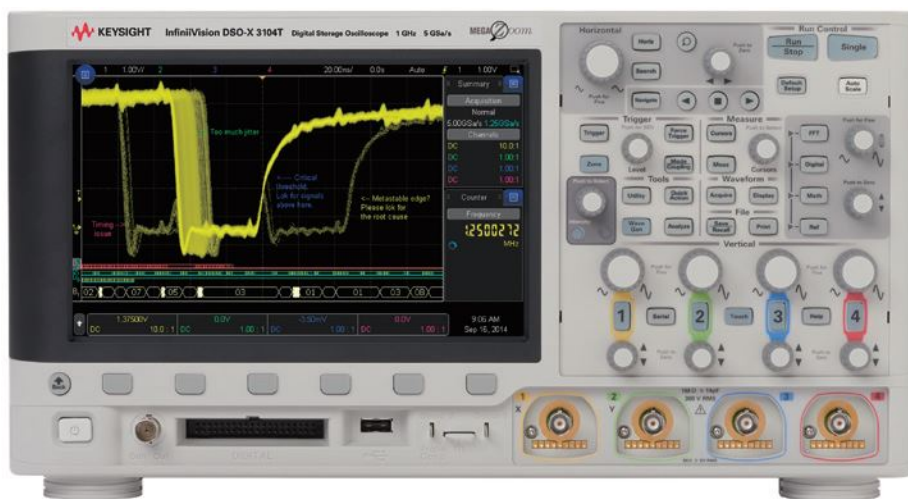
图 1: InfiniiVision 3000 X 系列示波器采用了 MegaZoom IV 智能存储器技术
