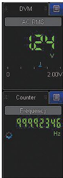
图 26: DVM 和计数器充分利用单独的信号路径, 不触发就可以进行测量, 同时还可以共享示波器的探头。
