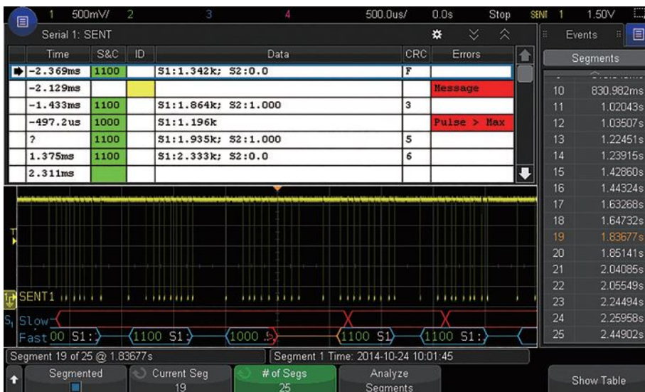
图 20: 分段存储器与串行解码配合使用, 能够对串行总线进行最深入的分析。
