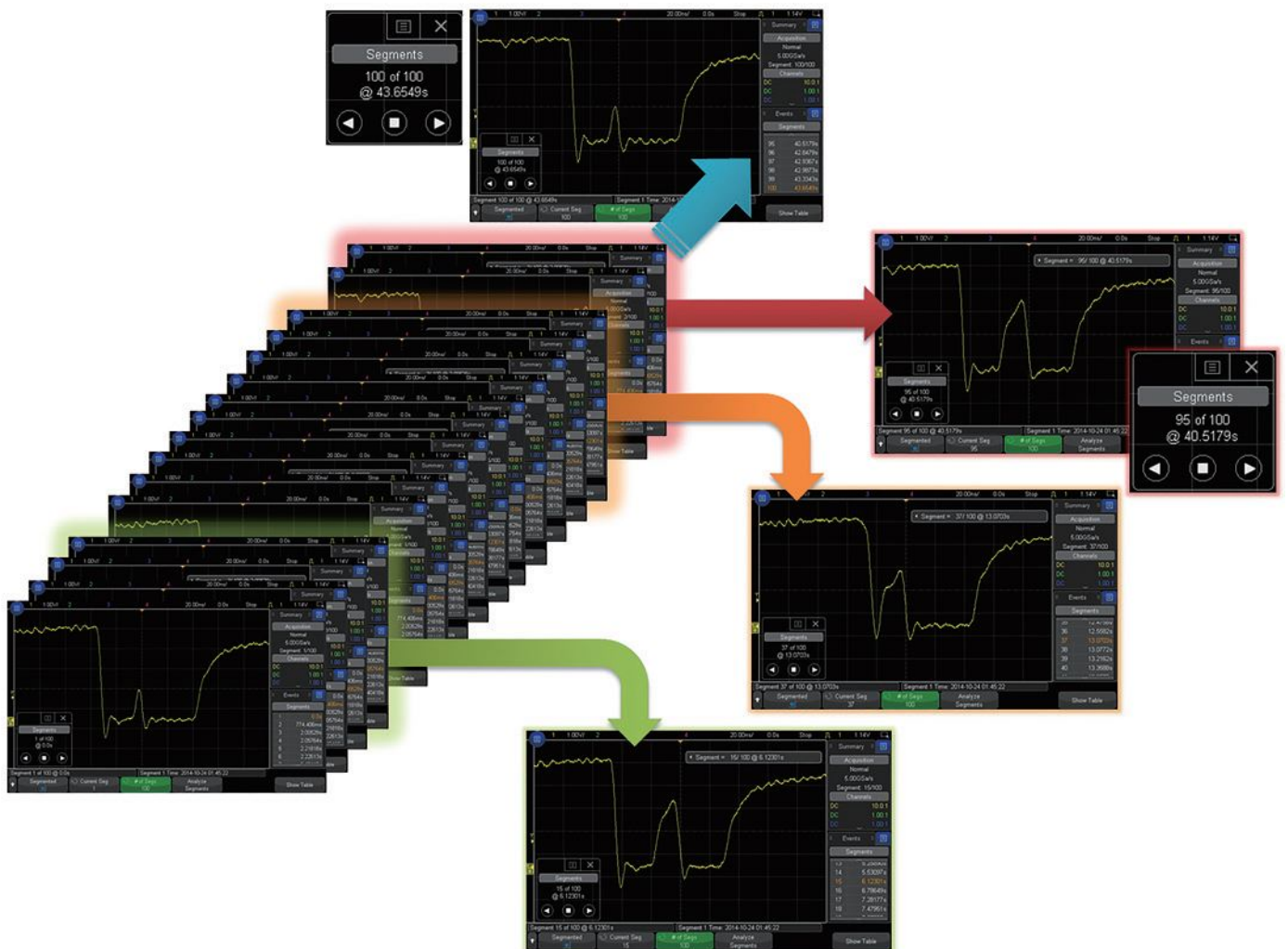
图13. 分段存储器揭示了所出现的不同类型的毛刺信号
