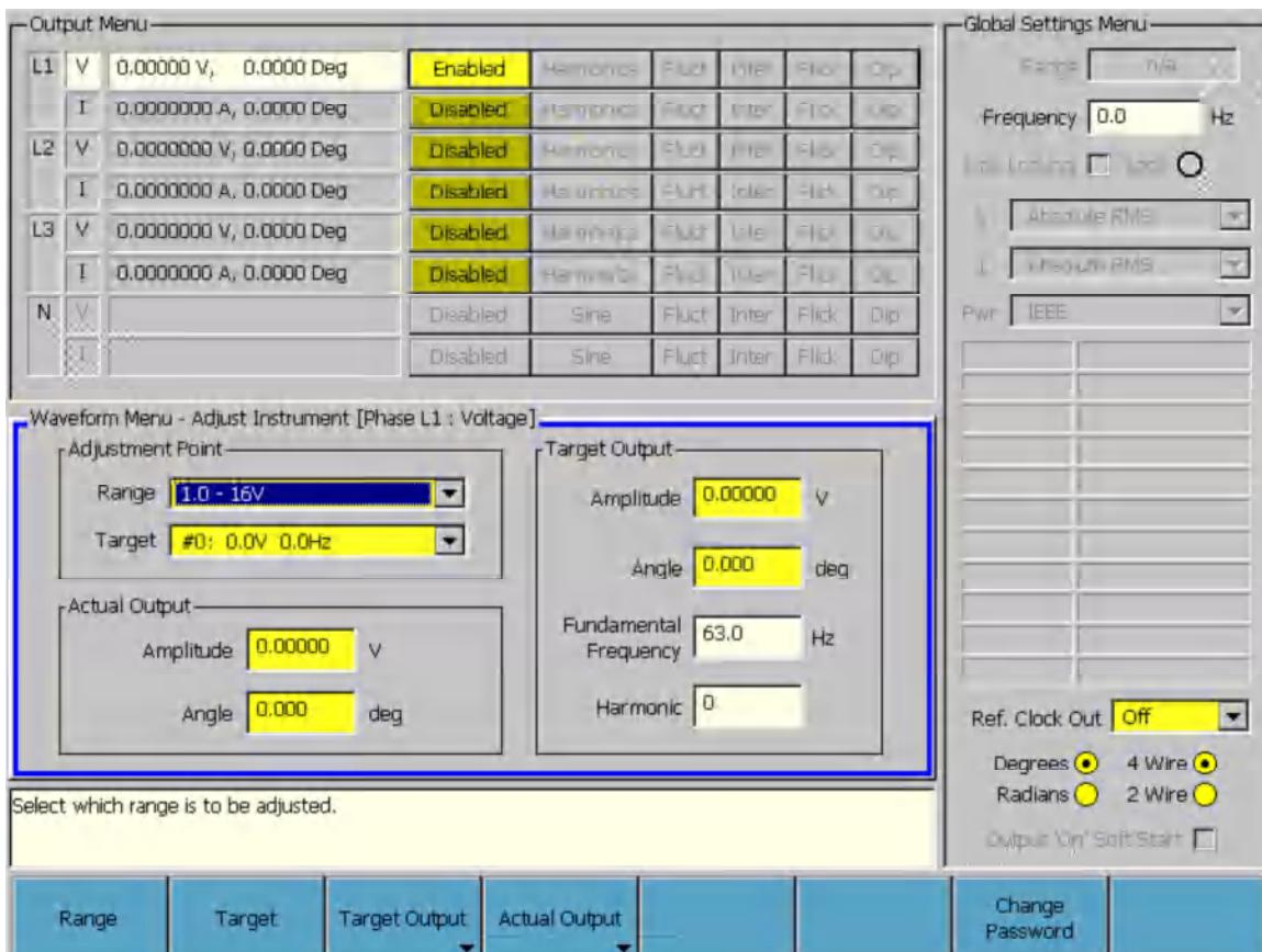
图 7-7. 校准调整仪器时的屏幕显示
