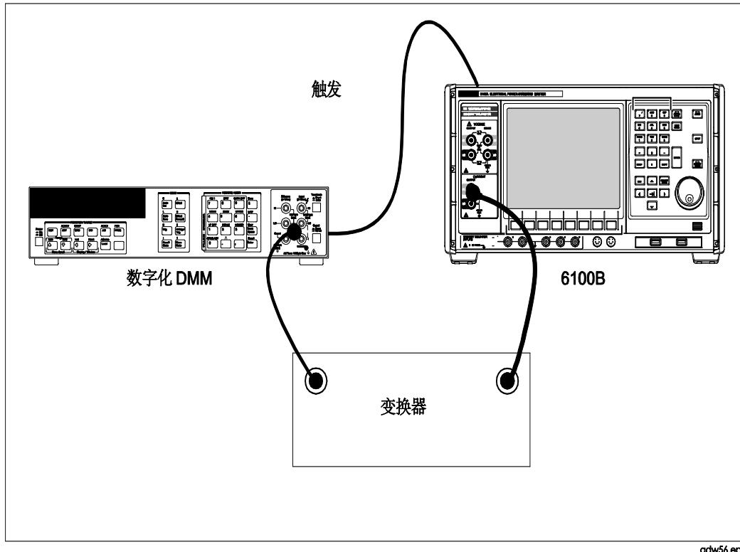
图 7-3. 相位测量的连接示意图
