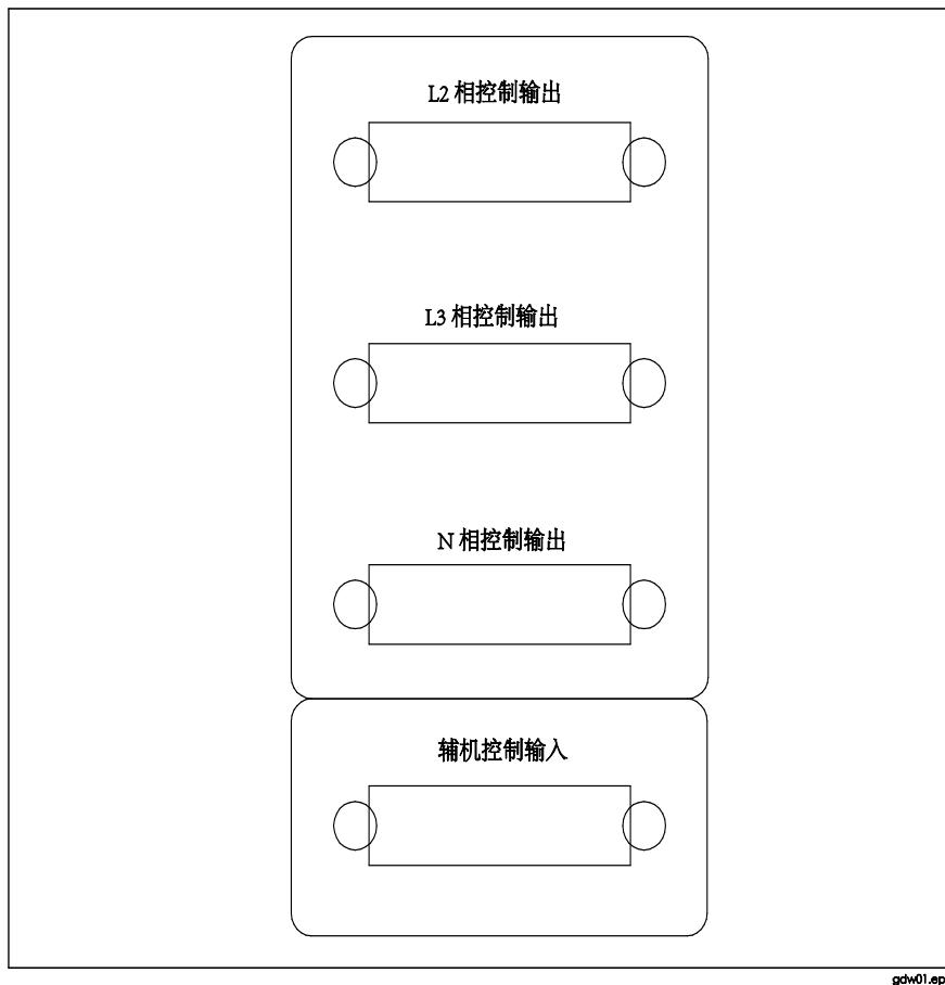
图 2-1 6105A 后面板上的辅机单元连接器
