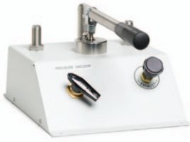
P5510 气体压力泵 (真空 ~ 2MPa)
