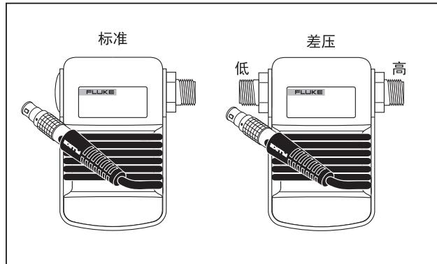
图 12. 表压模块和差压模块
