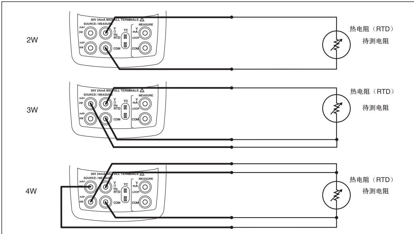
图 11.通过 RTD 测量温度，测量 2 线、3 线和 4 线电阻
