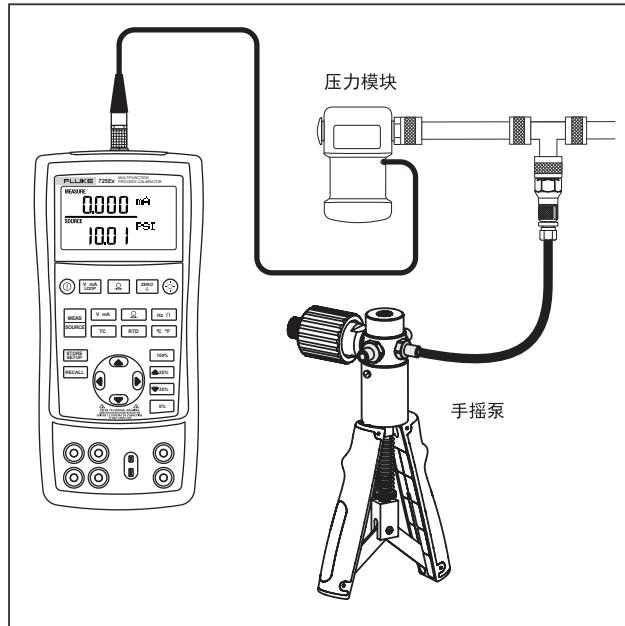
图 18. 用于输出压力的连接
