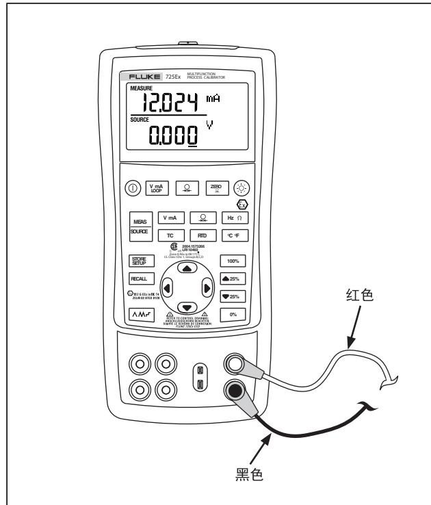
图 7. 测量电压和电流输出
