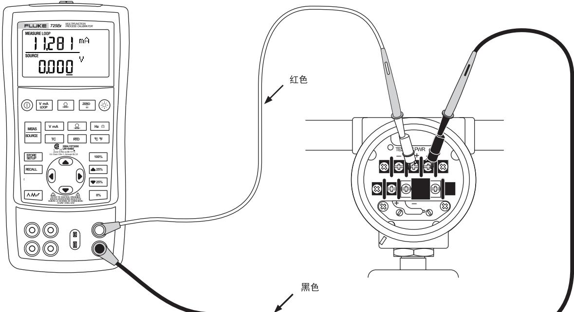
图 8. 供应回路电源的连接
