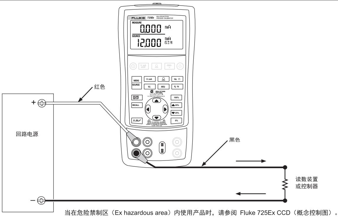
图 14. 用于在非爆炸危险区中模拟 4-20 mA 变送器的连接
