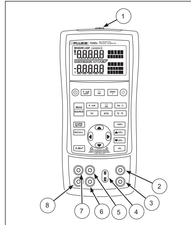
图 2. 输入/输出端子和连接器
