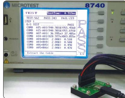
線材測試儀 NAC 系列機種量測 Type-c 線材，type-c 線材有四種接頭迴路狀態（正正、正反、反正、反反），線材測試儀會自動判斷迴路狀態。將四個迴路檔案用循序測試選取後，即可開始測試。
