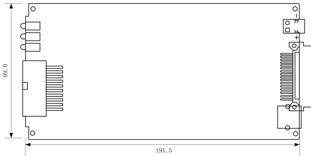
图 2.3 N8040A 板长宽尺寸 (单位: MM)
