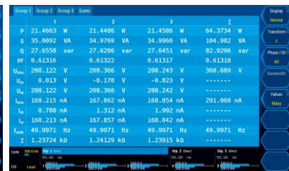
点击“Phase/CH”功能键： 所有通道的测量值或者同组的换算值
