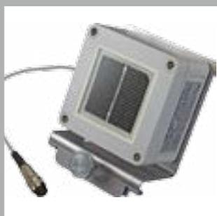
满足IEC/EN 60904-2标准的单晶参考组件（辐照度传感器），集成Pt1000温度传感器，10m长连接线
