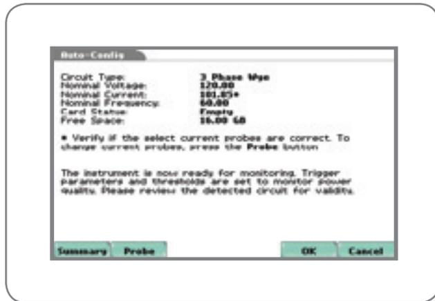
自动设置功能使得MAVOWATT20成为入手可用的工具。连接到负载，线路接通，自动设置开始启用，MAVOWATT20随即自动运行，它可以检测线路类型，额定电压和电流，显示结果无误后，按“确定”按钮，开始测量和记录。
