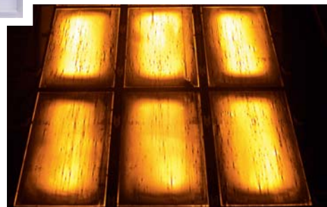
有破裂组件的CIS组串
