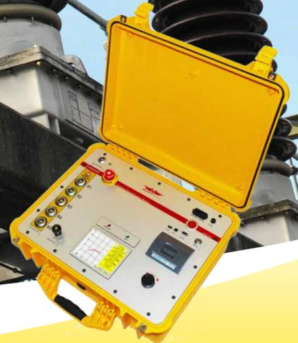
CT- T1 是一台基于微处理器的电流互感器测试仪，用于测量励磁电流，变比和极性判断，所以测试无需切换接头。CT- T1 和其它Raytech的型号一样，都是以精度为傲的产品，专为严苛现场环境而设计，2年产品质量和精度保证，让用户使用无忧。
