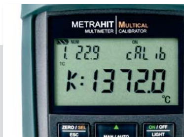
多种显示功能，如功能和输出值显示，测量值和校准值
