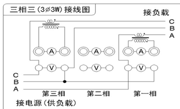
图 4-9 三相三线 (3P3W--CT) 接线图
