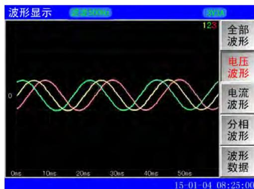
图 14-2 滤波后的变频器输出的电压波形
