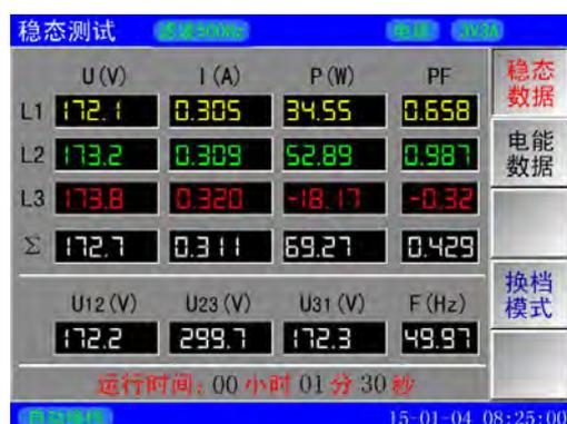
图14-4 滤波后的变频器输出的测量数据
