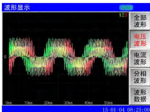
图 14-1 未滤波的变频器输出的电压波形
