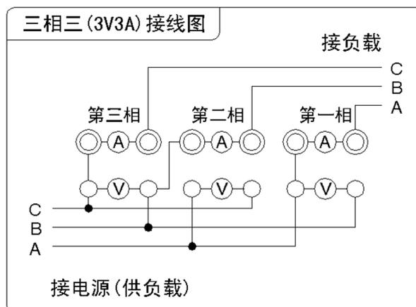
图 4-7 3V3A 接线图
