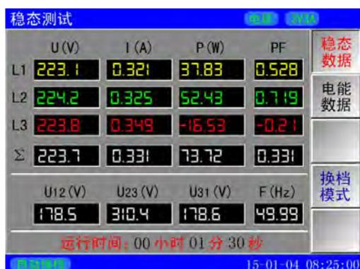
图14-3 未滤波的变频器输出的测量数据
