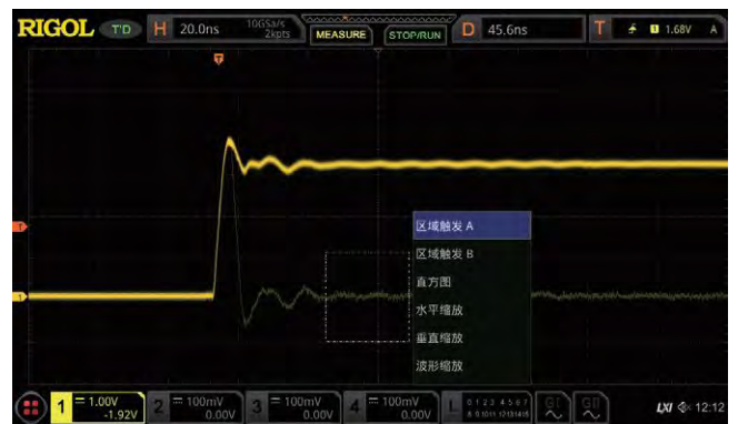
通过触摸手势在闪现的异常信号部分绘制一个矩形框，选择区域触发 A
