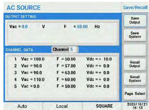
3. 按下Recall Output右侧的选择键，界面弹出如下浮窗，移动光标到设定区域，按下[3]数字键，并按下[Enter]键确认，将当前参数从Channel[3]调出；
