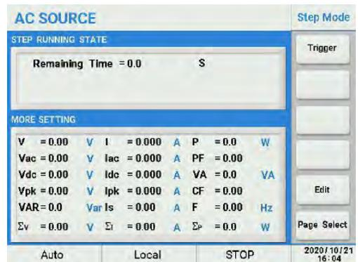
最大功率点扫描功能, 用于抓取最大功率点的电压和频率, 设置参数包括开始/结束电压, 步进电压值, 开始/结束频率, 步进频率以及单步时间, 使电源电压和频率按照设置步进改变, 测试结束之后可以显示最大功率点的电压、频率、电流参数。
