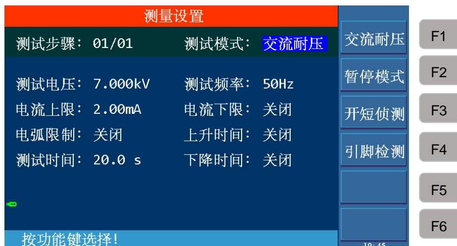
图 4-10 交流耐压测试模式
