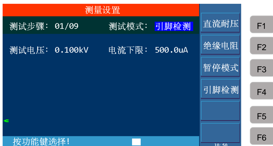
图 4-16 引脚检测设置
