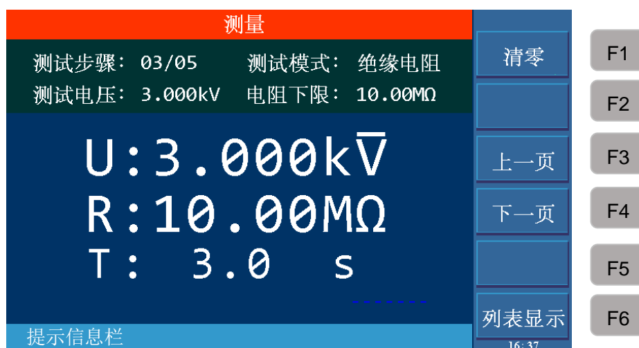
图 4-17.3 绝缘电阻测量界面
