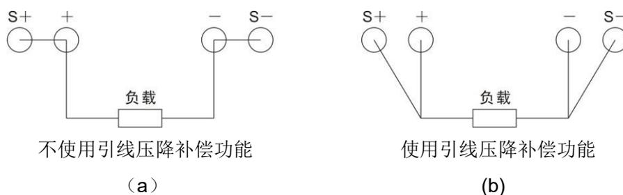
图 1-1 输出接线
