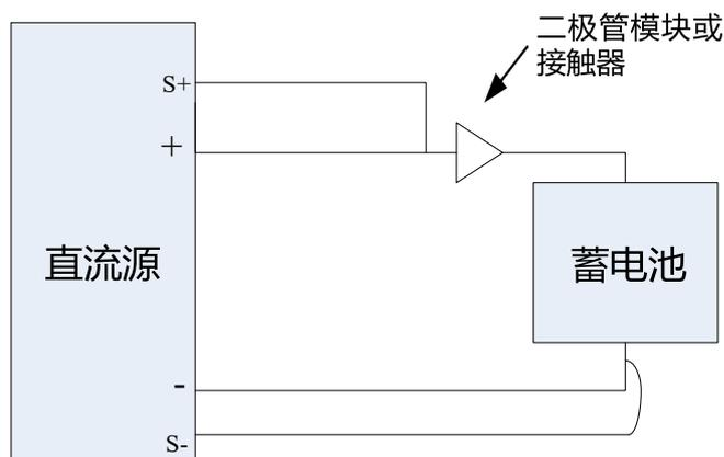
图 1-2 蓄电池负载接线方式
