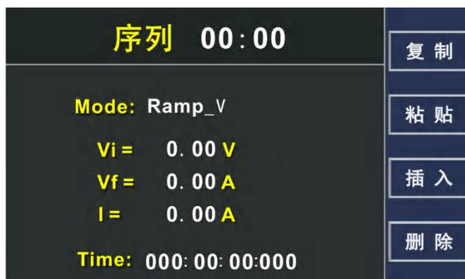
图 3-17 电压斜率模式
