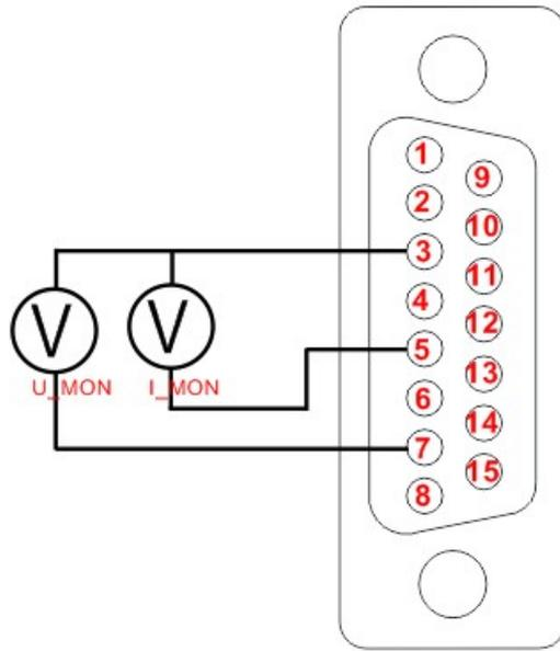
图 3-42 监视输出电压、电流值
