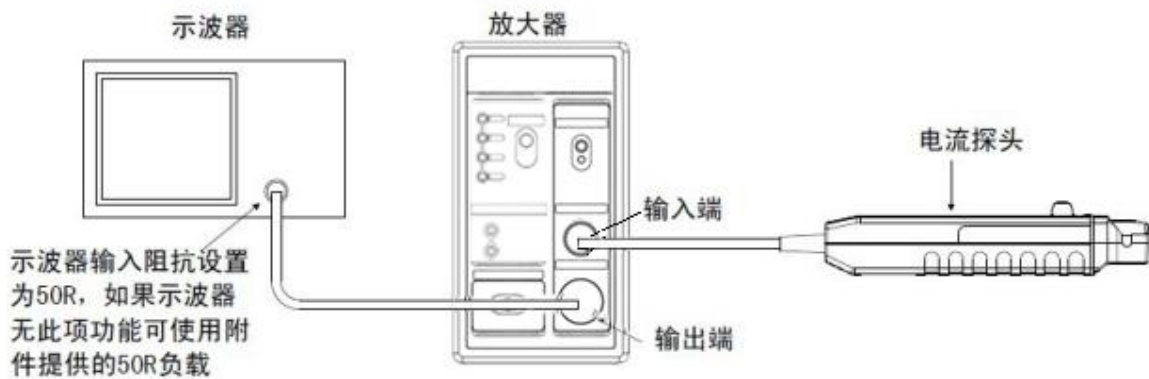
图 19 测试平台搭建示意图
