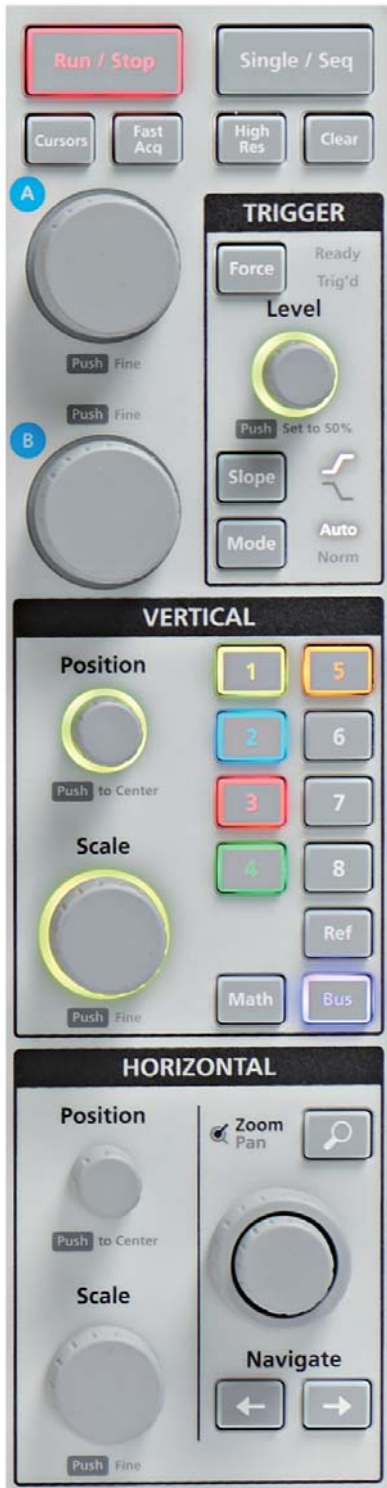
高效直观的前面板不仅提供了关键控制功能，还为大面积 15.6" 高清显示器留出了空间。
