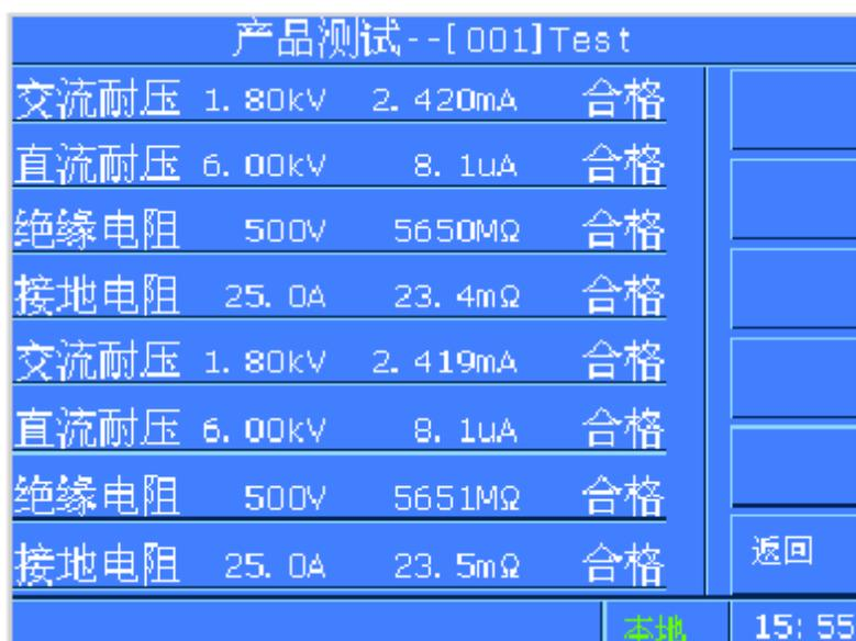
图 4-3-5 测试完成后以列表形式显示测试结果
