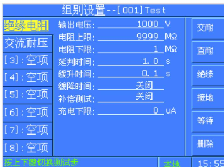
图 4-5-3 绝缘电阻设置界面
