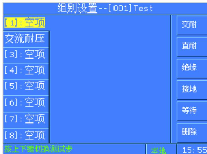
图 4-5-7 删除测试步后的参数设置界面
