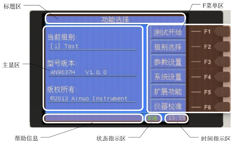
图 2-3-2 液晶面板示意图
