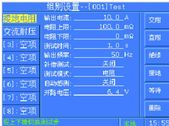
图 4-5-2 接地电阻设置界面
