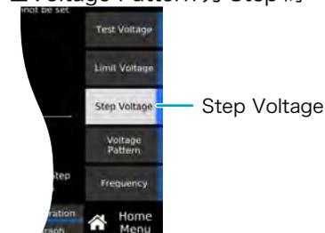
不需要 2nd Test Voltage 时, 无需更改 2nd Test Voltage 的设置。在电压的施加时间设置中, 请将 2nd Test Time 设为 OFF。
