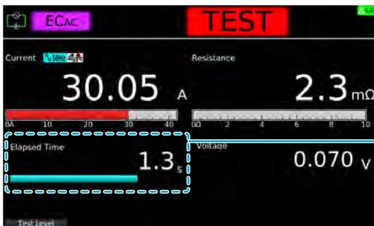
经过时间。Test Time 为开时，用条形图显示剩余的测试时间。
