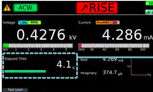
经过时间。用条形图显示剩余的电压上升时间。
