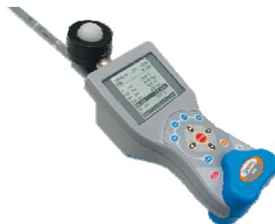
**测量参数：**空气温度、空气速度、空气流量、相对湿度、露点、温差（可选）、K型热电偶温度测量（可选）、照度、亮度（可选）、对比（可选）、黑球辐射温度（可选）、CO和CO<sub>2</sub>浓度。
