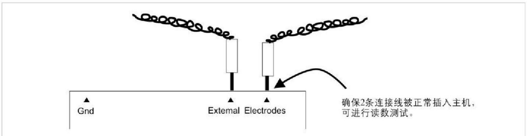
将连接好的电锤放在地板上开始测试，将两条连线的一端分别插入仪表的两个插孔，然后将其中一条接鳄鱼夹，另外一条与一个5磅重探头相联。将鳄鱼夹子接到接地点上，按照测量要求将盘形探头放在待测物体表面上。
