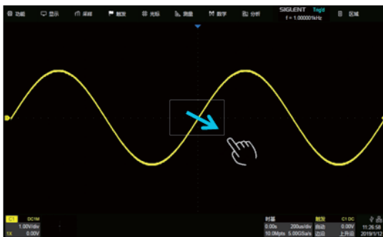
通过单点拖动手指绘制矩形框，手指移开屏幕出现菜单，可选择区域触发、直方图功能。在手势开始时请保持角度在 45^\circ 左右以保证仪器能正确识别为画框操作
