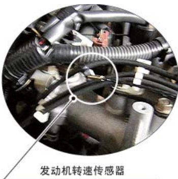
通过漏磁测量转速
