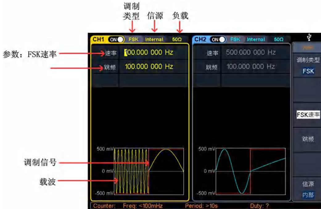
图 4-17：频移键控调制的用户界面
