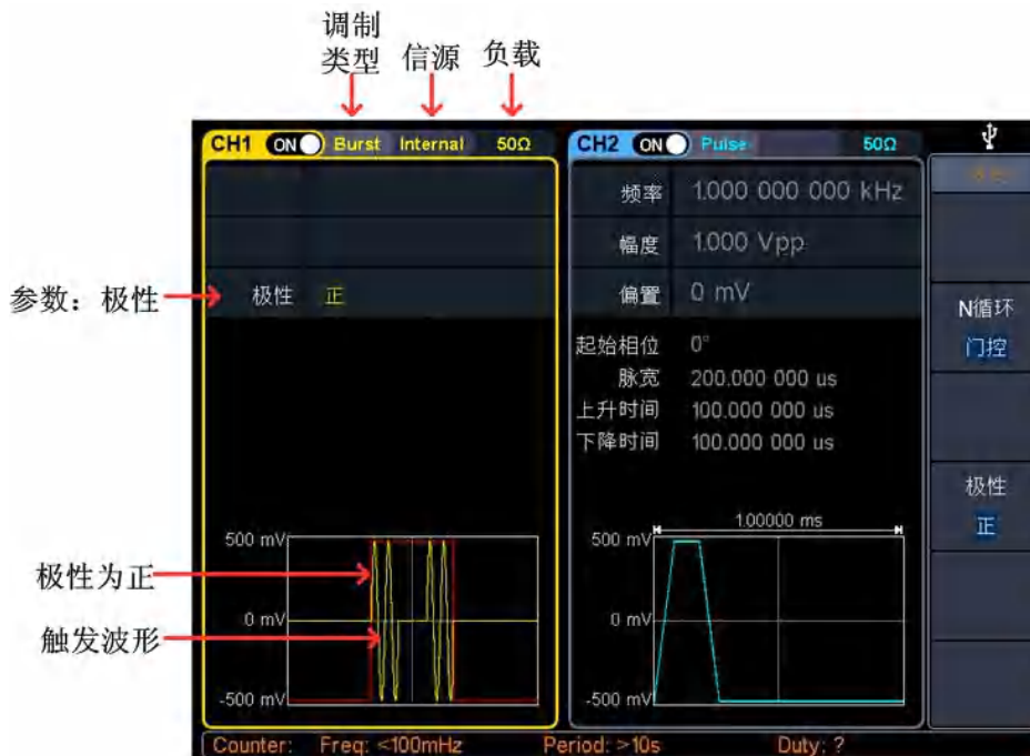
图 4-24：门控脉冲串的用户界面
