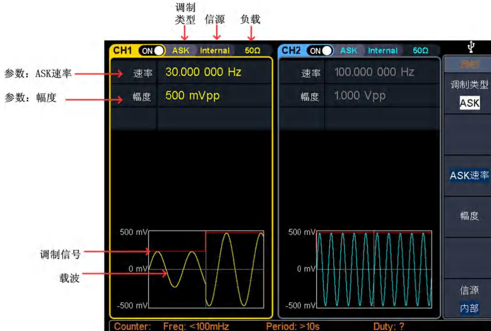
图 4-15 幅移键控调制的用户界面
