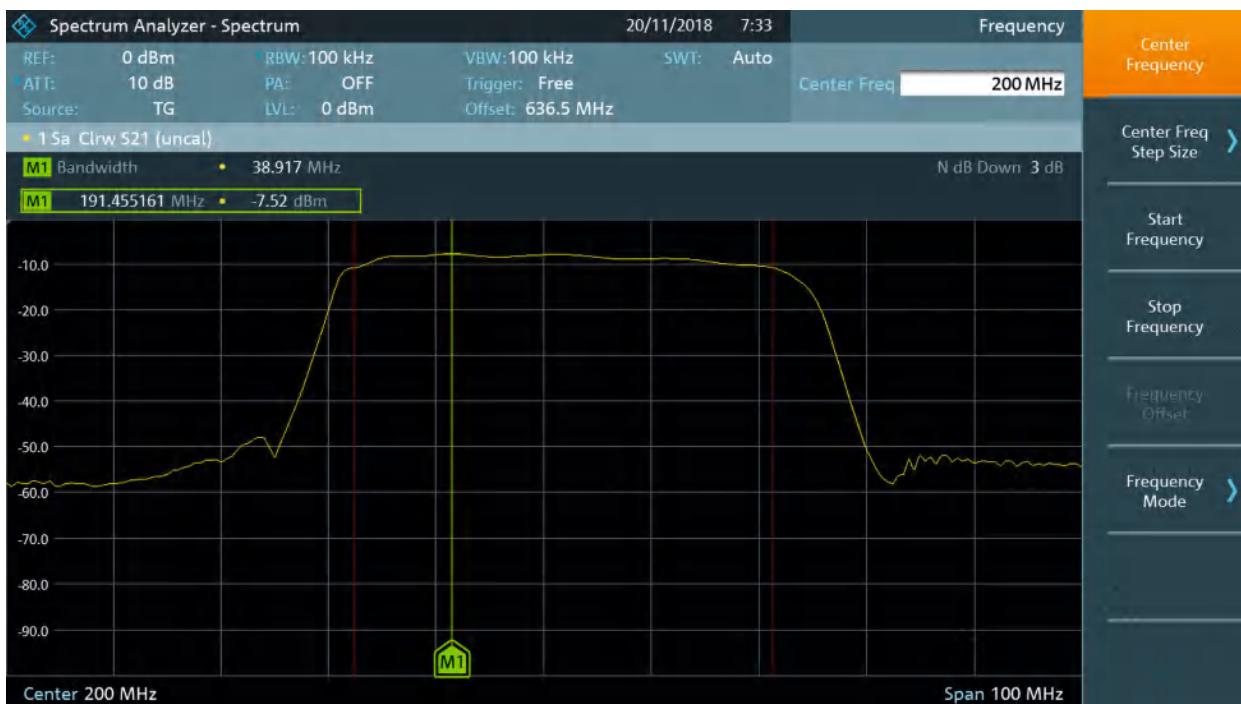
R&S®FPC1500：测量包含混频器、滤波器和放大器的信号链的跟踪源
