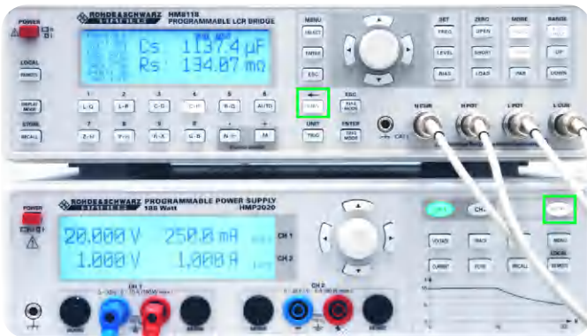
Abb. 7.6: Externe BIAS Vorspannung aktivieren
