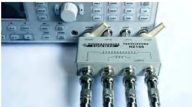
Abb. 8.6: Anschluss des Messadapters an der LCR-Messbrücke
