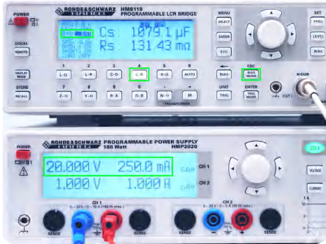
Abb. 7.5: Externe BIAS Vorspannung einstellen
