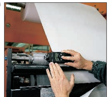
机械式测量转轮的转速
