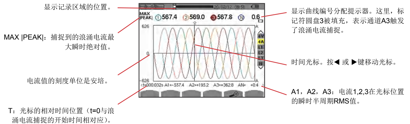
图48：三相五线连接的4A 峰值显示页面
