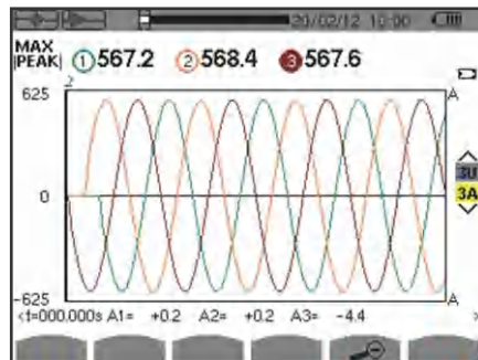
图49：三相三线连接的3A 峰值显示页面
