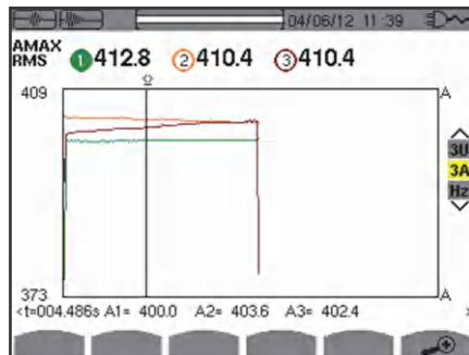
图45: 三相不含中性线连接的3A RMS显示页面
