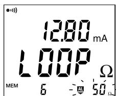
当阻抗测量<1 Ω时，显示屏会交替显示测量值和LOOP，此种情况表明测量值对于地回路阻抗来说过低。
