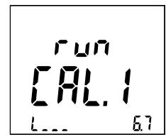
步骤6/7设备执行电流测量调整的第三步。
