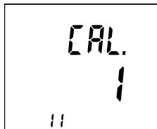
步骤1/7设备交替显示 100 mA SET 和 PRESS RT。. 钳口夹住电流为100mA的电缆，之后按►键。
