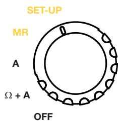
将旋转开关调整到 SET-UP
