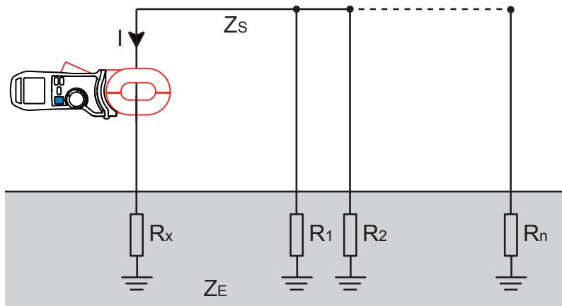
被测量的接地电极  $R_x$  通过接地  $Z_E$  和防护线  $Z_s$  与其他接地电极并联。
