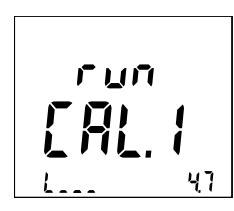
步骤4/7设备执行电流测量调整的第二步。
