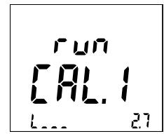
步骤2/7设备执行电流测量调整的第一步。
