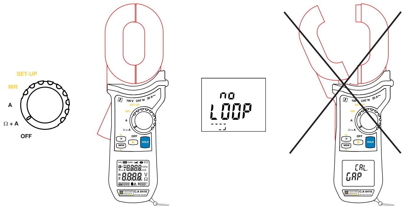
如果设备无法调整，则显示Err. CAL. 报告错误。此时，请关闭设备，检查铁间空隙是否干净无污物，重新启动。
