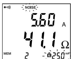
在测量阻抗过程中，如设备显示NOISE符号，表明电流太高 (> 5 A) 或电压太高 ( $Z \times I > 50 V$ )。这种情况不能保证测量结果。
