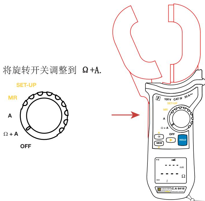
按动扳机打开夹钳的钳口，夹住要测量的环路中的导体。
