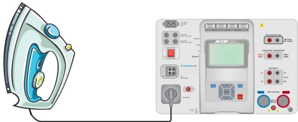
图 4.25: 绝缘电阻测量(插座 LN - PE)
