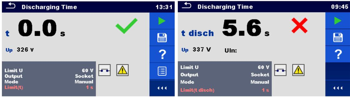
图 4.53: 放电时间测量结果示例（输出=插座）
