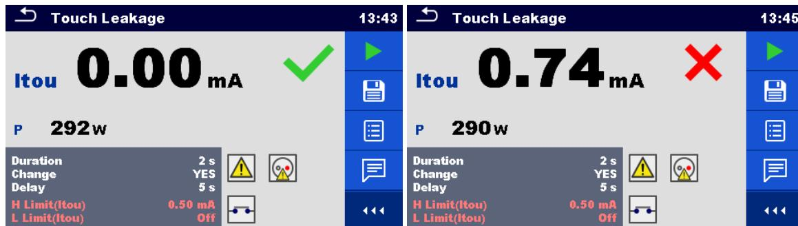
图 4.41: 接触漏电流测量结果示例
