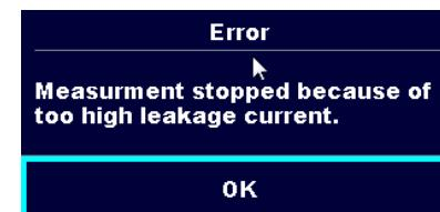
实测漏电流 (Idiff、Ipe、Itouch) 超过 20 mA。中止测量。按下确认继续。
