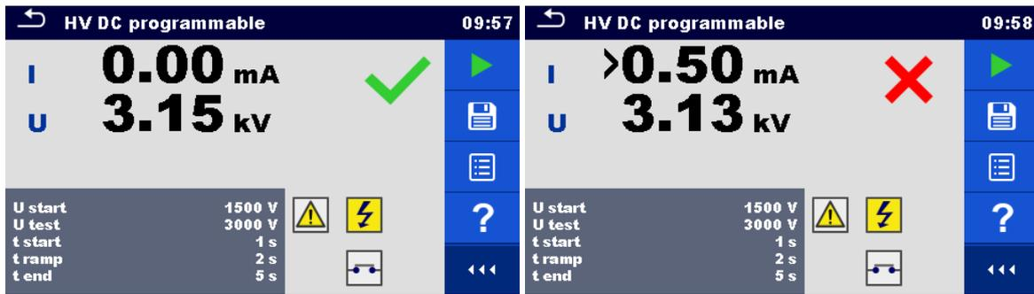
图 4.22: HV DC 可编程测量结果示例
