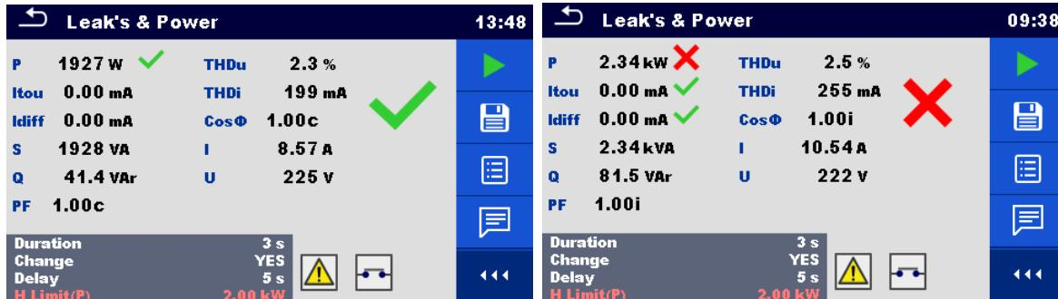
图 4.47: 漏电流与功率测量结果示例
