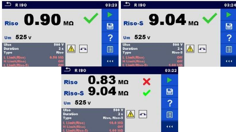
图 4.27: 绝缘电阻测量结果示例
