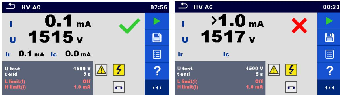
图 4.12: HV AC 测量结果示例
