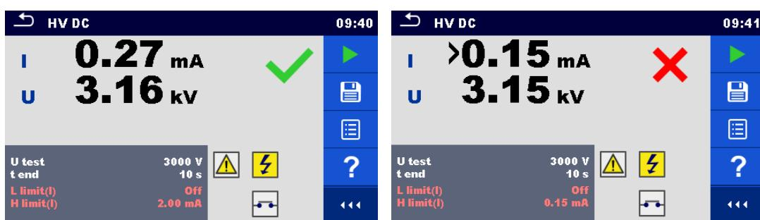
图 4.15: HV DC 测量结果示例
