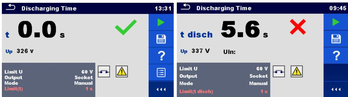
图 4.53: 放电时间测量结果示例（输出=插座）
