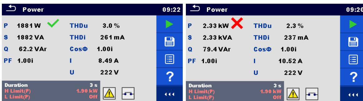
图 4.44: 功率测量结果示例
