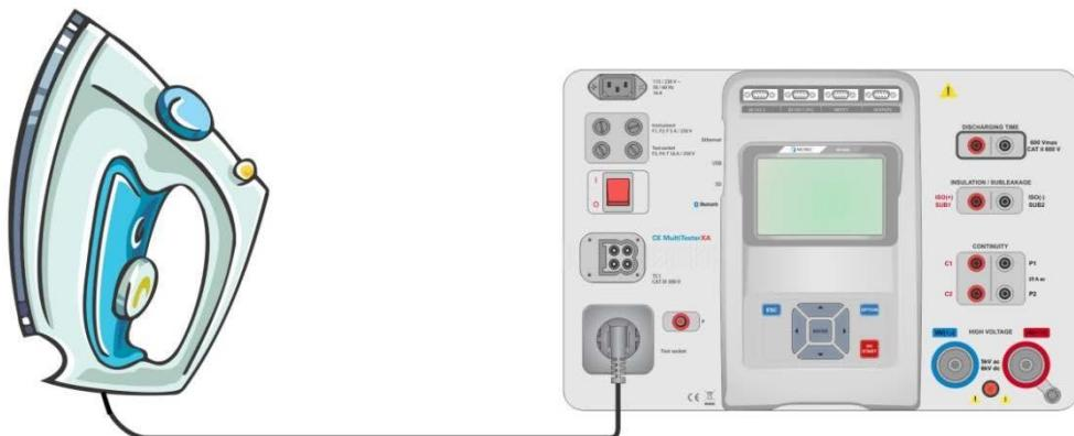
图 4.30: 临界漏电流测量(插座 LN - PE)
