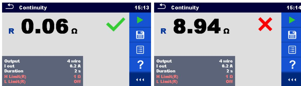
图 4.7: 导通性测量结果示例
