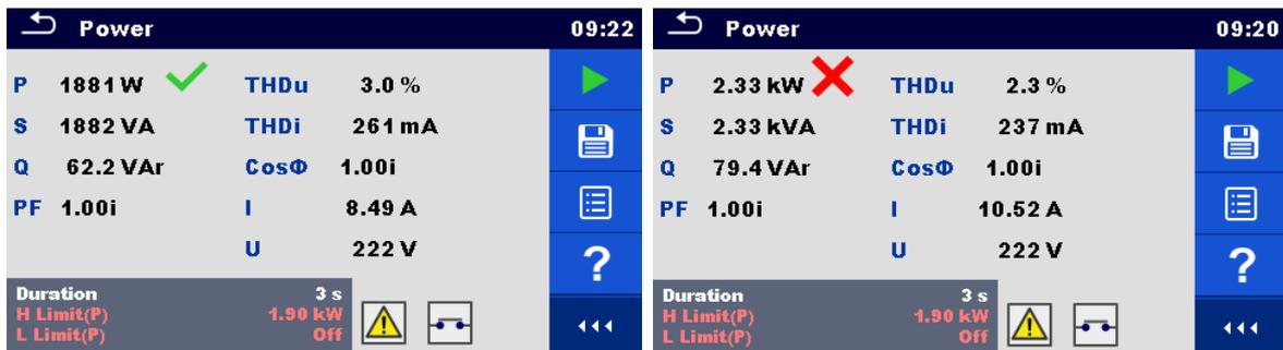
图 4.44: 功率测量结果示例
