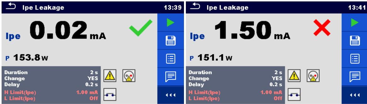
图 4.38: 接地漏电流测量结果示例
