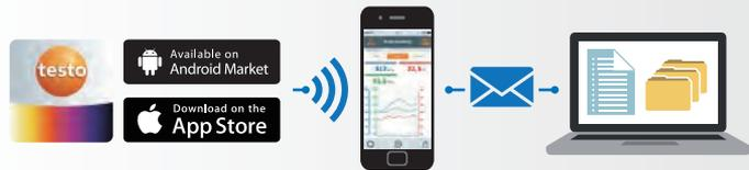
APP下载—蓝牙连接，APP远程操作测量仪器—创建测量报告，发送电子邮件至PC端
