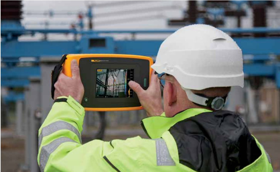
ii910 超声波局放成像仪, 在高电压应用中检测到局部放电而生成的图像。
