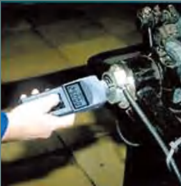
接触型转速测量
