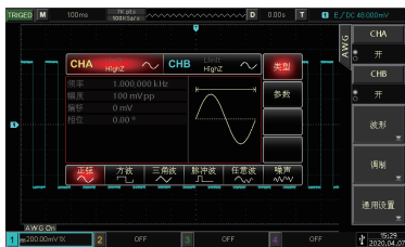
7 内置双通道50MHz信号发生器
