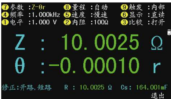
1 简易操作测试界面，四参数同时显示
