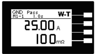
6. 如果直流接地阻抗測試失敗時，ESD-140 的程式不會輸出訊號到耐壓測試器的 TEST 輸入端子上，耐壓測試器不會執行測試。
