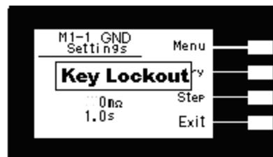
隨後又回到原先的畫面。因此必須先解除鎖定，才能進行測試參數的設定。請參照鍵盤鎖定的說明，解除鍵盤的鎖定。
