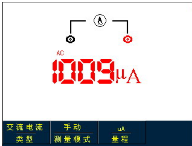
图 5-10 小于 4mA 交流电流测量
