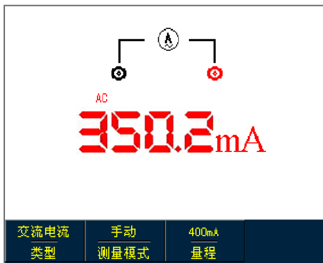
图5-19 测量40mA-400mA的交流流电流
