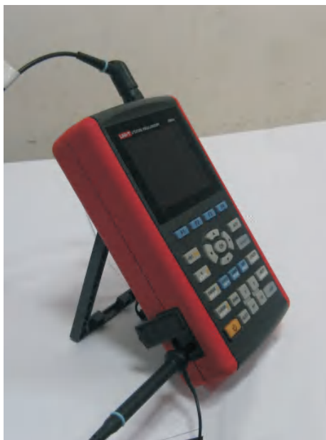
图3-2 本机补偿信号连接
