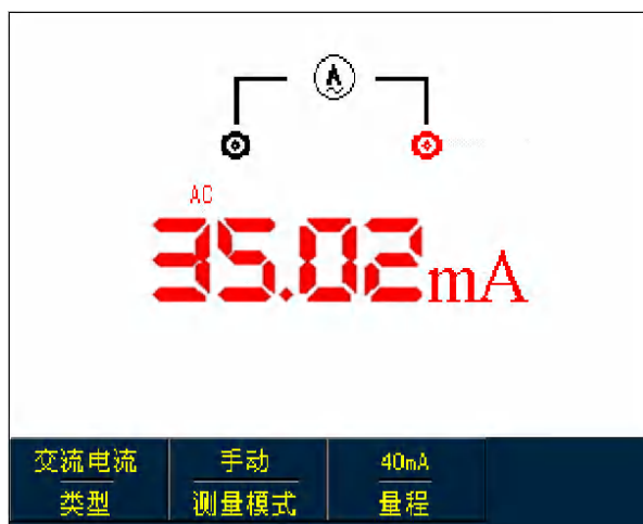
图5-18 小于40mA交流电流测量
