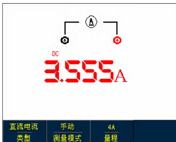
图5-16 大于400mA直流电流测量
