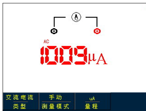
图5-17 小于等于1mA交流电流测量
