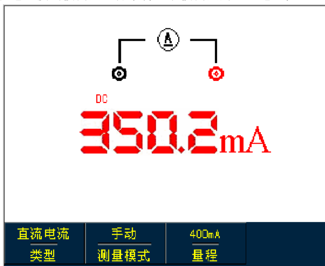
图5-15 测量40mA-400mA的直流电流
