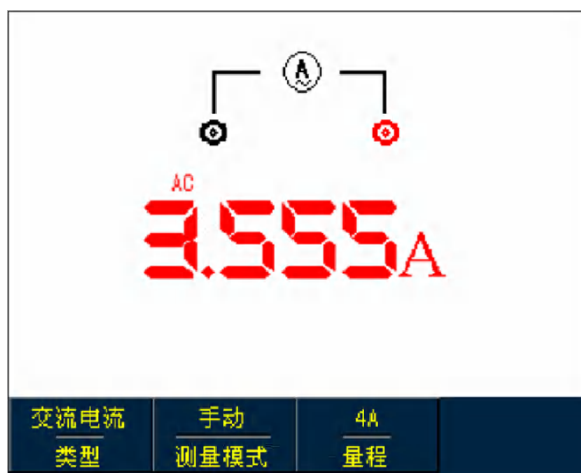
图5-20大于400mA交流电流测量
