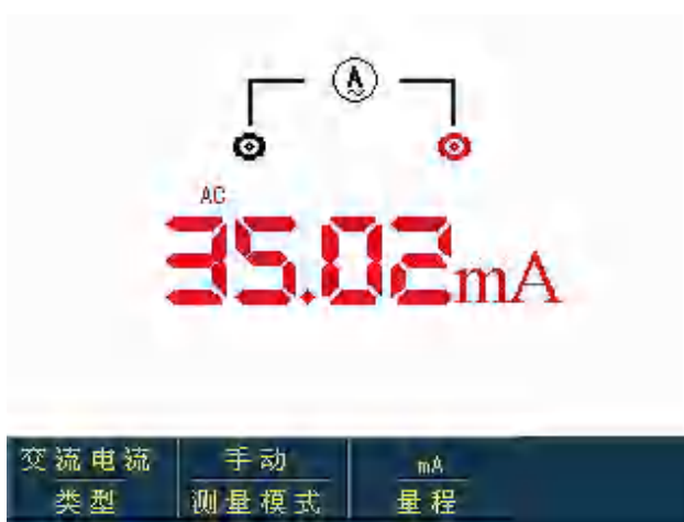
图 5-11 小于 400mA 交流电流测量
