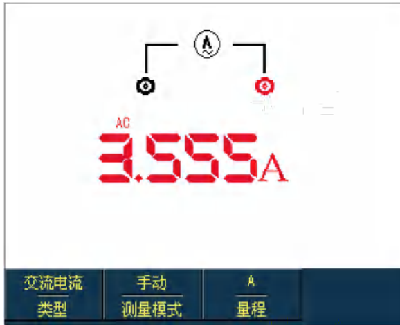
图 5-12 大于 400mA 交流电流测量
