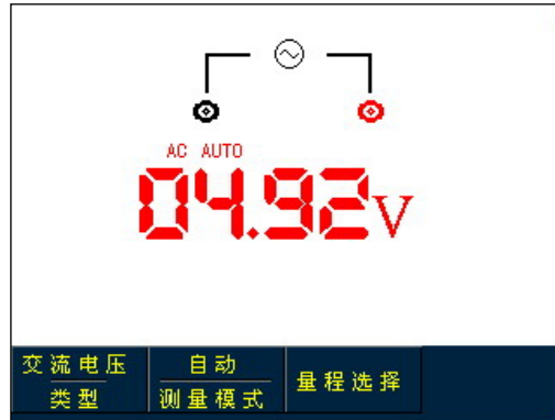
图5-6 交流电压测量
