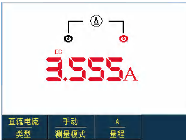
图5-9 大于400mA直流电流测量
