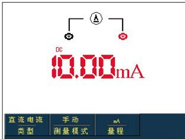
图5-8 小于400mA直流电流测量
