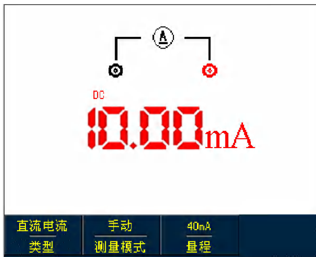
图5-14 小于40mA直流电流测量
