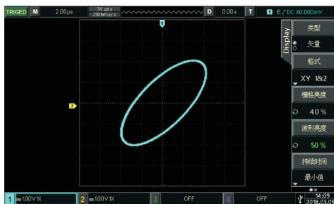
图7-1 XY模式下的波形显示
