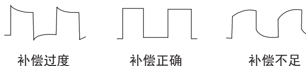
图1-2 探头补偿校正
