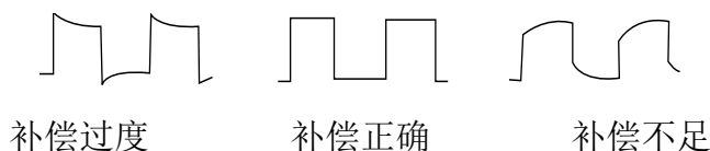
图 1-2 探头补偿校正
