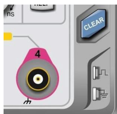
图 1-1 探头补偿信号连接片和接地端
