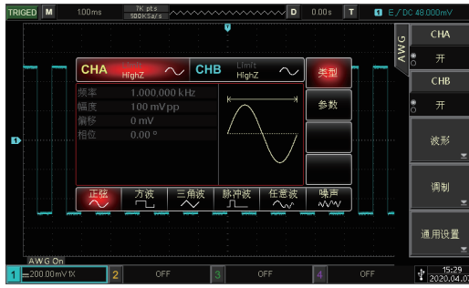
7 内置双通道50MHz信号发生器
